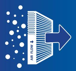
Le filtre HEPA ou *High Efficiency Particulate Air*, dont l'équivalent français serait « Haute Efficacité pour les Particules d'Air ». Les filtres de média HEPA sont les plus connus pour leur utilisation dans les aspirateurs. Il permet de filtrer l'air avant qu'il ne sorte de l'appareil et de retenir les différents particules et allergènes.
