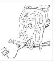
Assurez-vous que la raclette est propre et que les lames ne sont pas usées. Chargez la machine en branchant le chargeur intégré.
