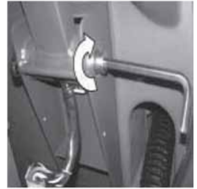
3. Insérer l'assemblage de poignée entre les douilles. Insérez le boulon à épaulement à travers la douille et vissez dans l'assemblage de poignée avec la clé fournie.
