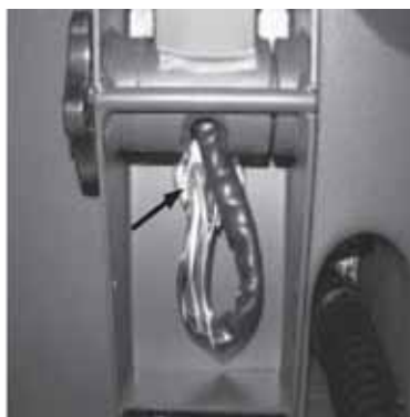
7. Le faisceau de câbles doit être aligné avec les motifs sur le connecteur pour s'adapter.
