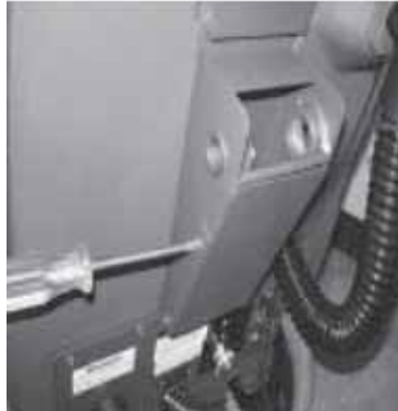
2. Utilisez un tournevis Phillips pour dévisser 4 vis et retirer le couvercle.
