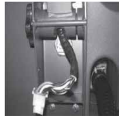
6. Fixez le faisceau de câbles à la machine.
